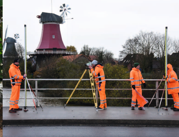
Messtrupp beim Nivellement
